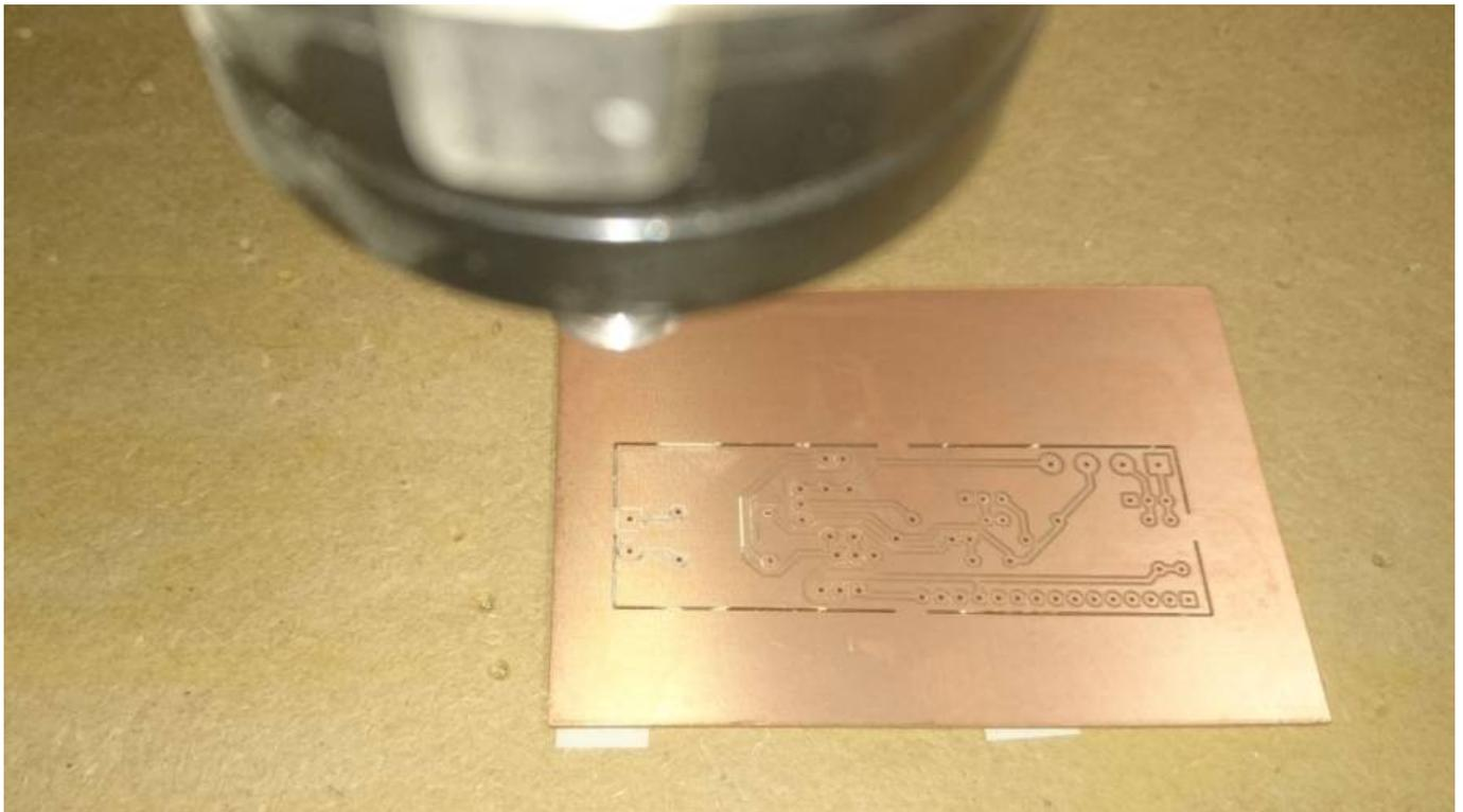
Ceci est une page de prise de notes pour de premiers essais de réalisation de circuits imprimés à l'aide de la CNC en simple face.
