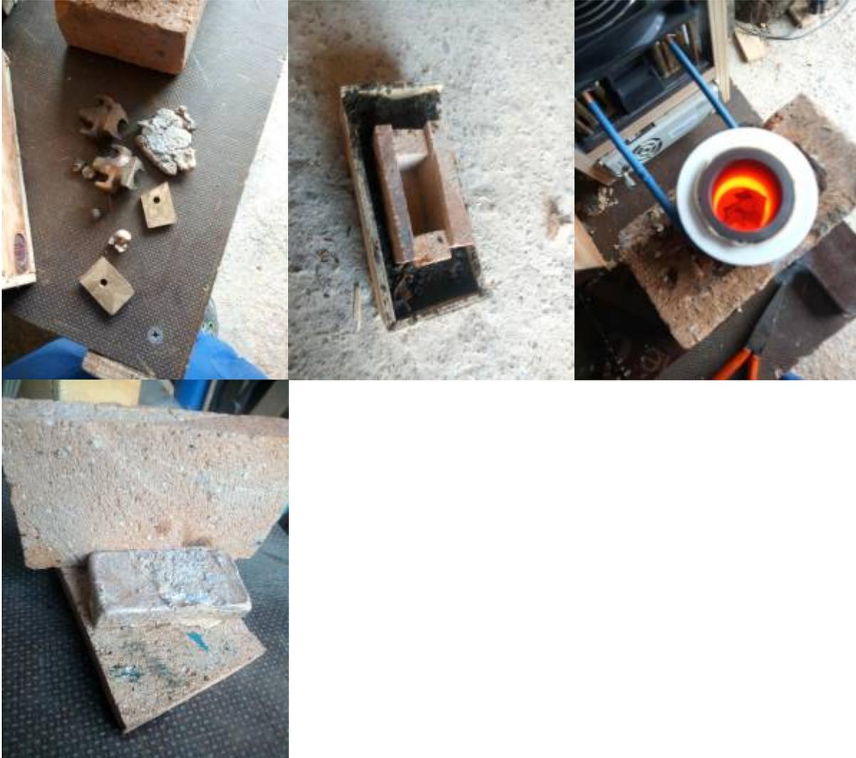
étape 1 : on récupère des vieux morceaux de laiton (ici des cosses de tableau électrique des échecs de fonderie avec un post a arc (ca marche pas...))
