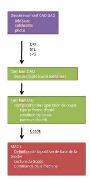
1 préparer le dessin pour qu'il soit lisible par cam bam en résumé simplifier au possible cam bam peut lire du format DXF pour la 2D et du STL pour la 3D
